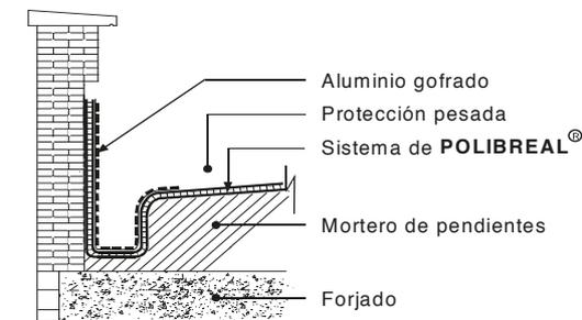
Figura 8- Canalón integrado en el borde del faldón
