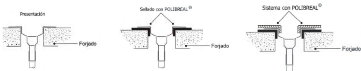
Figura 6- Sumidero vertical sobre forjado resistente
